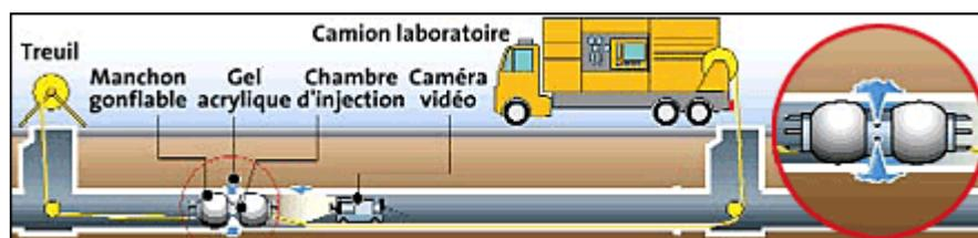
Image 10 : Schéma d'étanchement de canalisation par injection<sup>8</sup>
